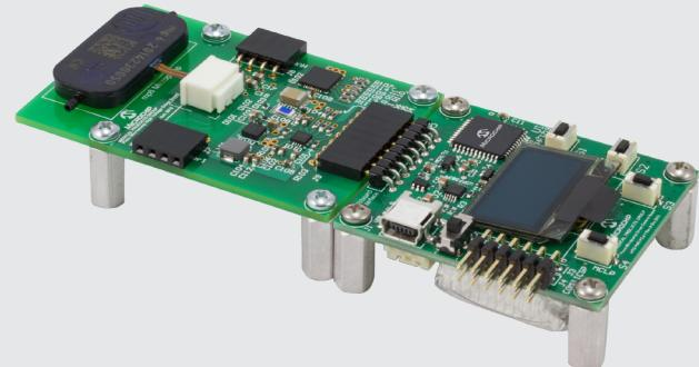
Microchip医疗MEMS微型泵演示板展示了一个经济高效的给药设备的独特实现。在Microchip PIC16F1719 8位MCU上，集成的独立于内核的外设可大幅分担MCU内核在处理采用压电微型泵的给药设备的控制功能时的负载。这些功能包括为高压驱动器功能提供电源、可调电压和频率控制信号。
