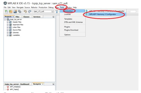
从 MPLAB X IDE 的 Tools 菜单,选择 Embedded,MPLAB Harmony3 Configurator,打开 MHC。
