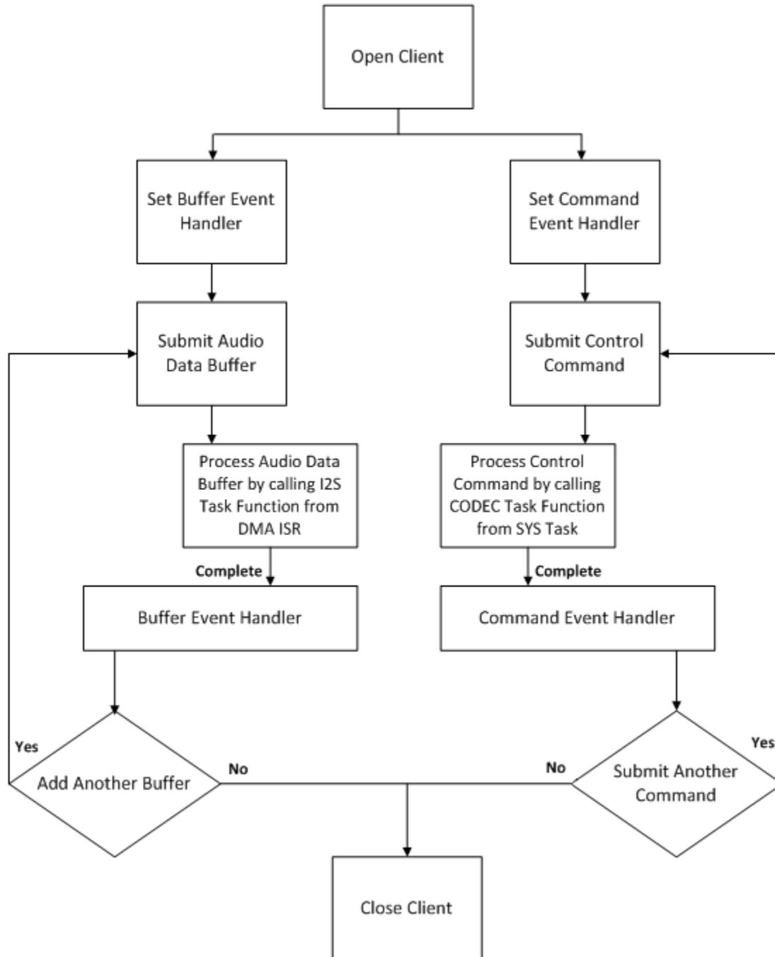
应用程序首先通过调用具有相同模块索引的DRV\_CODEC\_Open函数来将AK4642编解码器驱动程序打开两次。该操作将获得两个驱动程序句柄。在打开的两个客户端中，一个用于写音频数据（耳机功能），另一个用于读数据（麦克风功能）。
