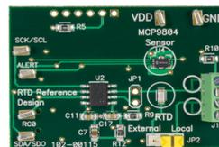
Microchip还提供了一个使用电流源对RTD进行偏置的参考设计。该解决方案使用一个高性能 $\Delta$ - $\Sigma$ 模数转换器（ADC）、两个外部电阻和一个参考电压来按比例测量温度。通过单点校准，可在 $-200^{\circ}\text{C}$ 至 $+800^{\circ}\text{C}$ 的RTD温度范围内实现 $\pm 0.1^{\circ}\text{C}$ 的精度和 $\pm 0.01^{\circ}\text{C}$ 的测量分辨率。
