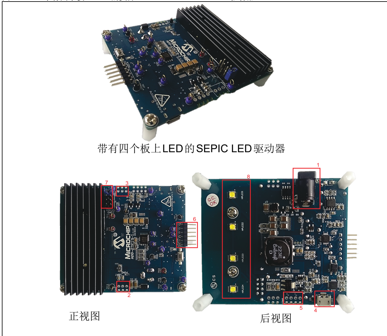
图B-1： 带有四个板上LED的实际PIC16F1769 SEPIC LED驱动器
